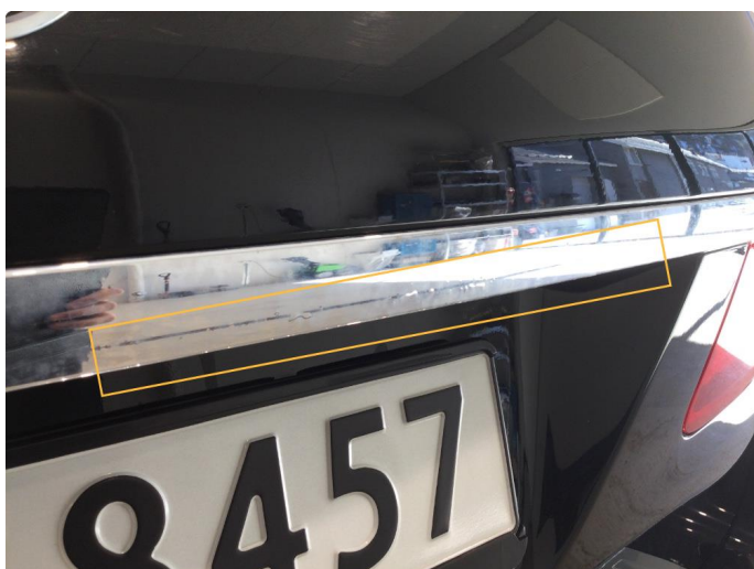
1.3 Korrosjon på list over skiltplate bak
