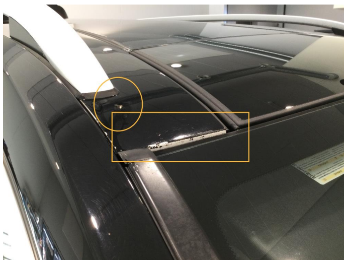
1.7 Slitt lakk på taket over frontruten
