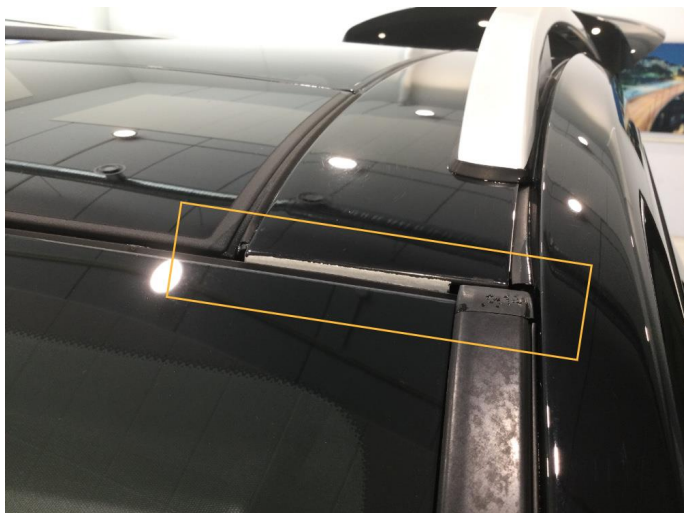
1.7 Slitt lakk på taket over frontruten
