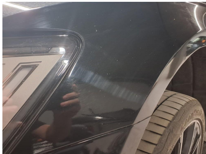
1.3 Noe steinsprut på frontfanger
