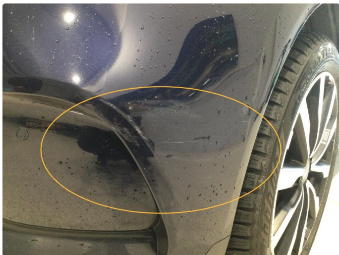
1.4 Noe merke på frontfanger, venstre side
