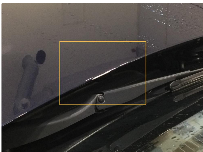
1.2 Noe merke på panser etter vindusvisker
