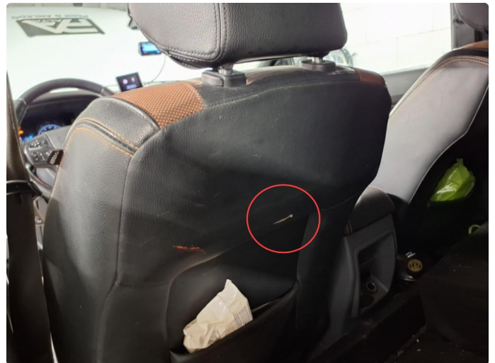
3.1 Skade på setetrekk
