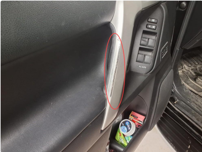
1.1 Slitt på innvendig dørhåndtak på førersiden
