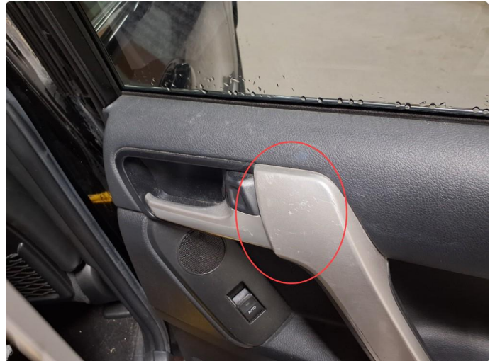
1.3 Noe slitasje ved dørhåndtak på høyreside bak
