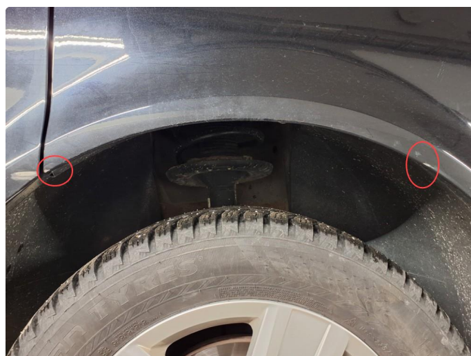
1.6 Ripe(r) ned til grunning
