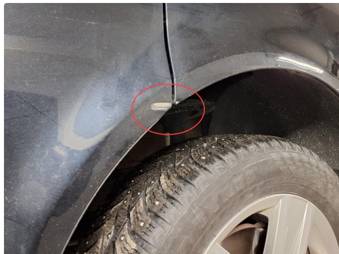
1.4 Ripe ned til grunning
