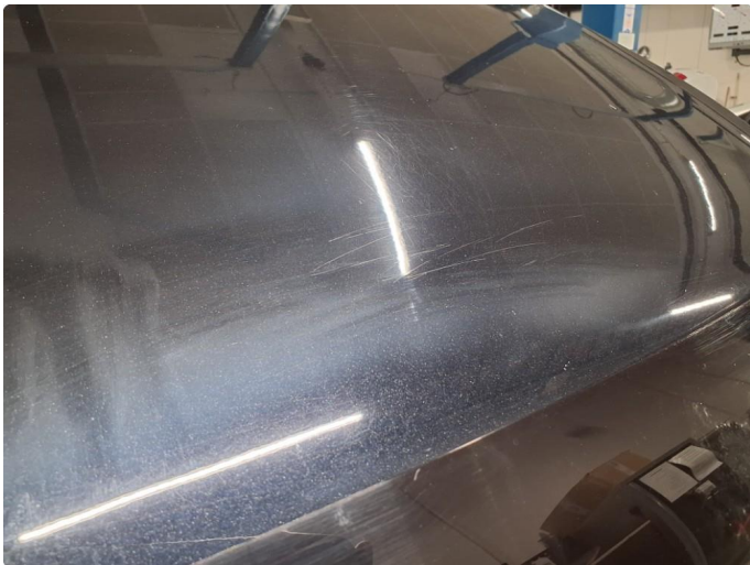
1.1 Noe riper på panser
