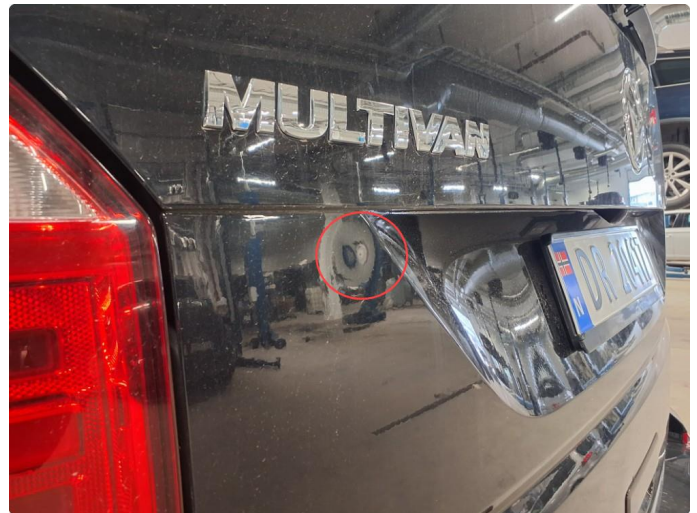
1.2 Bulk med lakkskade på bakluke
