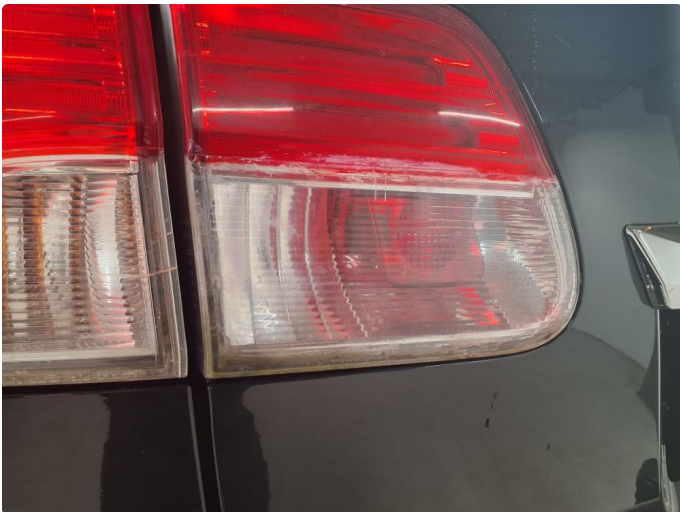
2.1 Sprukket glass på baklykt, venstre side
