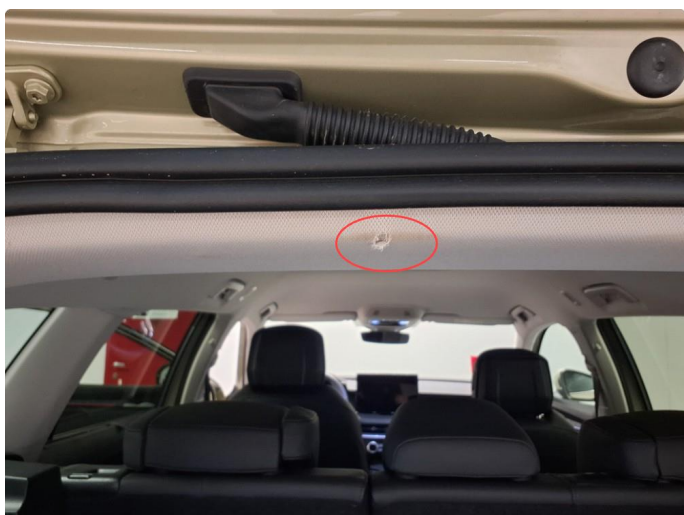
3.1 Merke i taktrekk ved bagasjeluken
