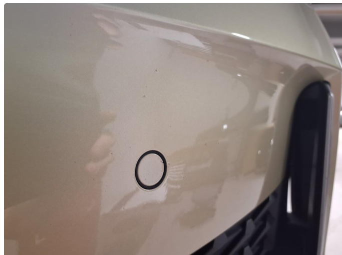
1.2 Noe steinsprut på frontfanger
