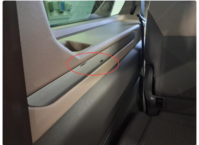
2.1 Merke i dørtrekk høyre bak
