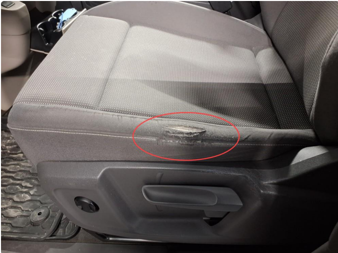
2.2 Skade på setetrekk , forsøkes utbedres
