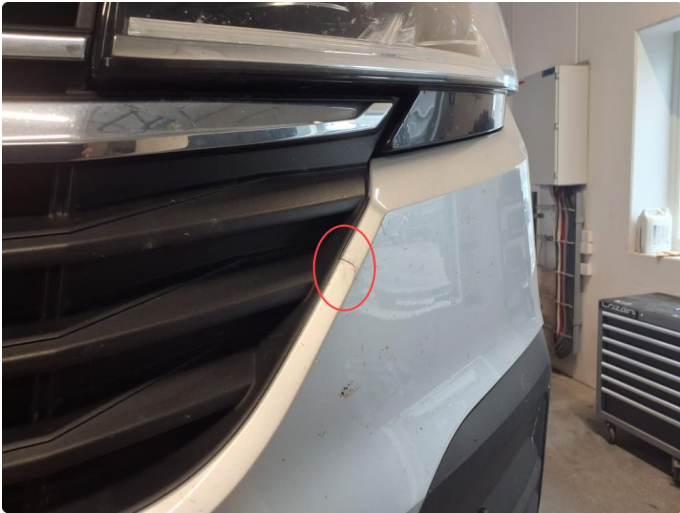
1.3 Liten sprikk i frontfanger, blir skiftet
