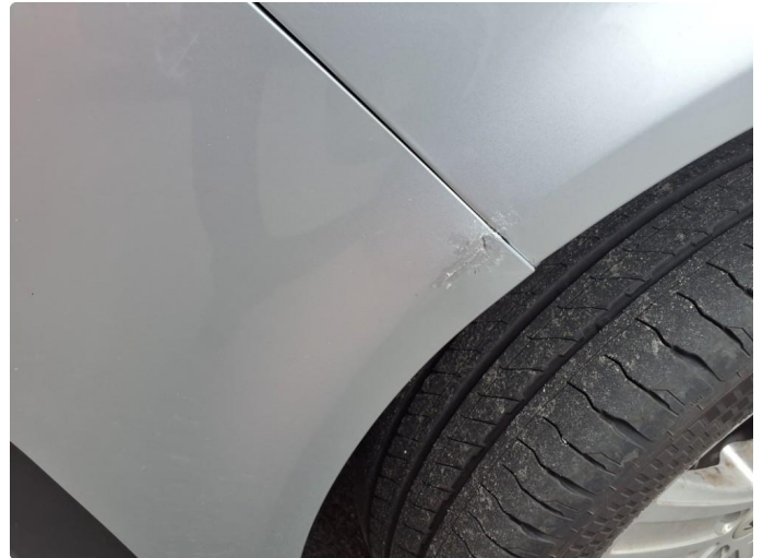
1.3 Liten sprikk i frontfanger, blir skiftet
