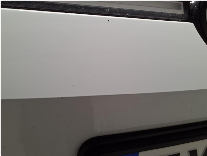
1.2 Noe steinsprut på frontfanger
