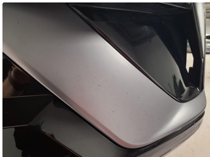
1.3 Noe steinsprut på frontfanger
