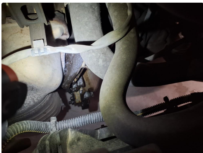
3.1 Oljelekkasje fra motor
