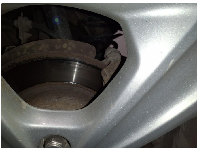
3.1 Noe rust bremseskiver bak
