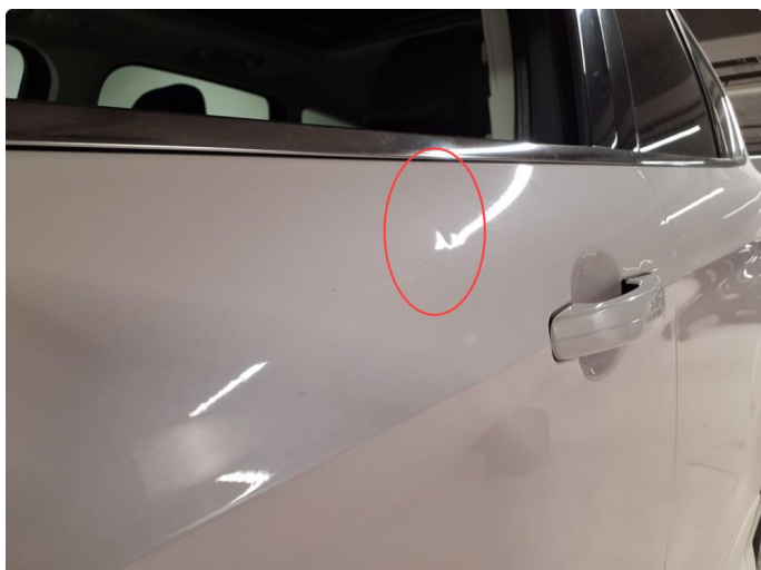
1.2 Noe bulker i dører
