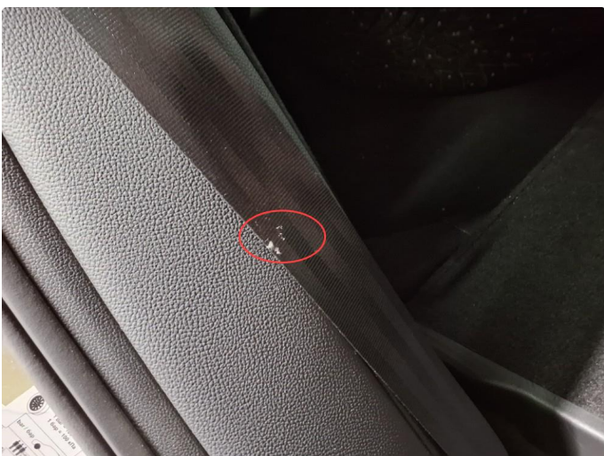
2.1 Skade på belte
