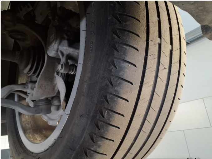
1.1 Skjev slitasje på sommerdekk
