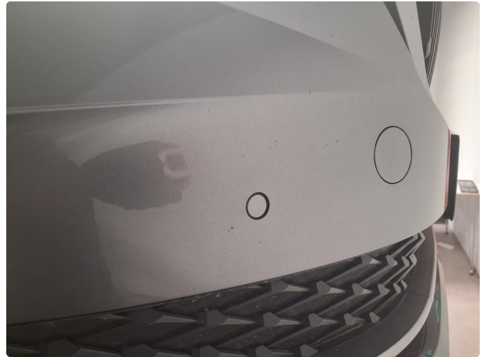
1.3 Noe steinsprut på frontfanger
