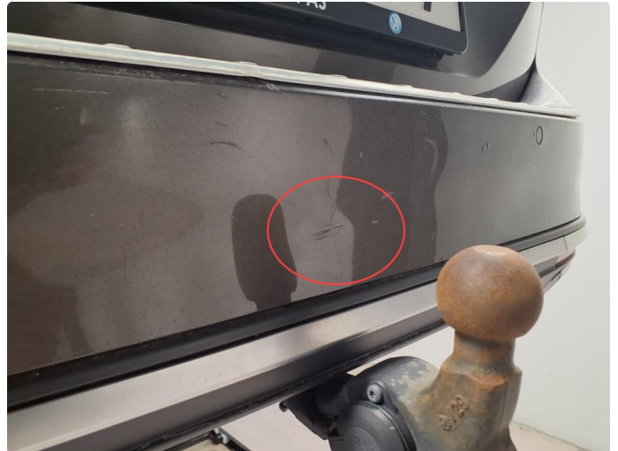
1.4 Bulk med lakkskade
