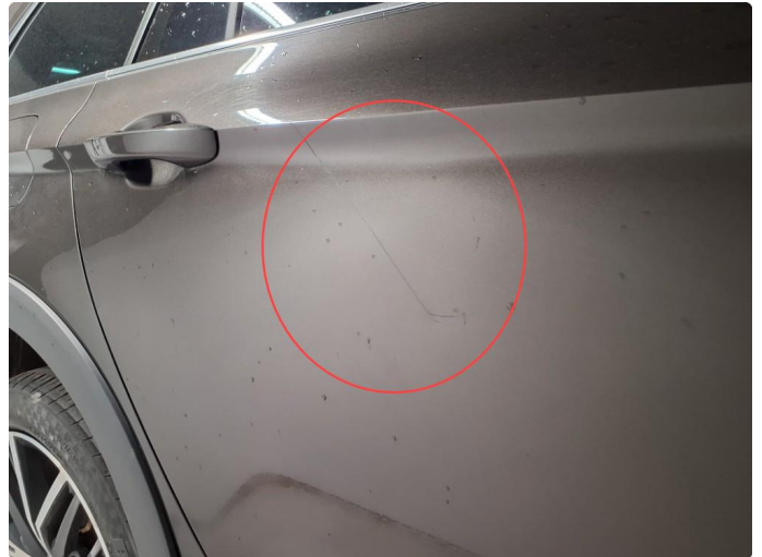
1.2 Bulk med lakkskade
