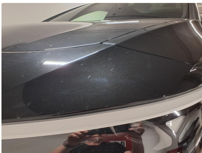
1.5 Noe steinsprut på frontfanger
