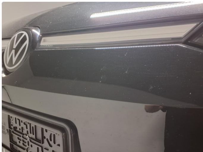
1.4 Noe steinsprut på frontfanger
