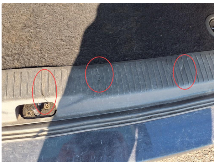
2.3 Noe skader i deksel ved innsteg til bagasjerom
