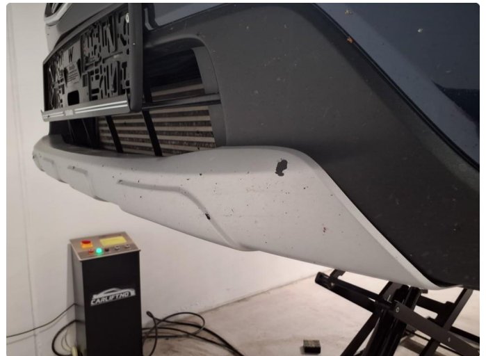
1.5 Lakk flasser på nedre del av støtfanger
