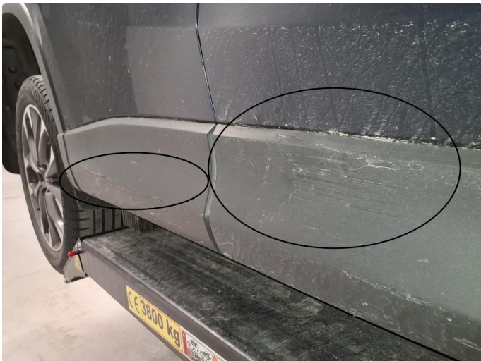
1.3 Merke på dører høyre side
