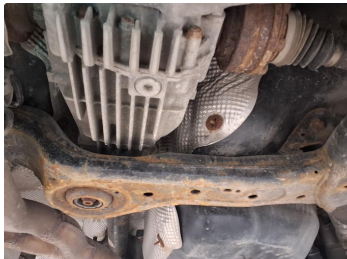
2.3 Rust på understell
