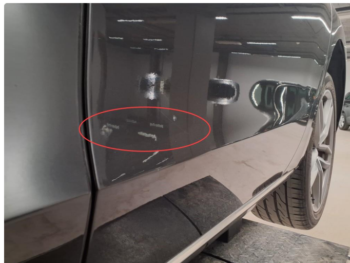
2.5 Noe rust på venstre bakdør
