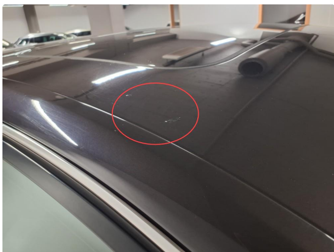
2.10 Noe rust på tak
