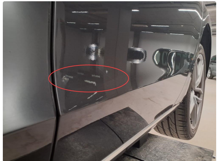
2.5 Noe rust på venstre bakdør
