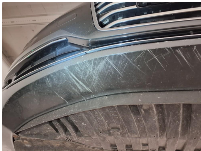
2.9 Skrubbskader underkant av frontfanger
