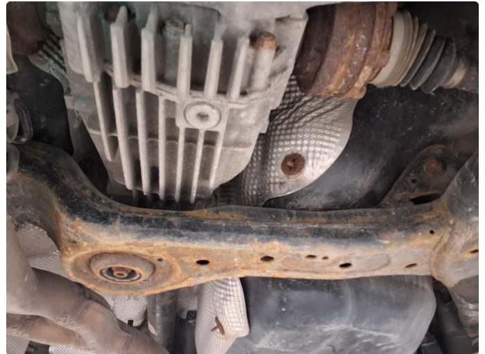
2.3 Rust på understell
