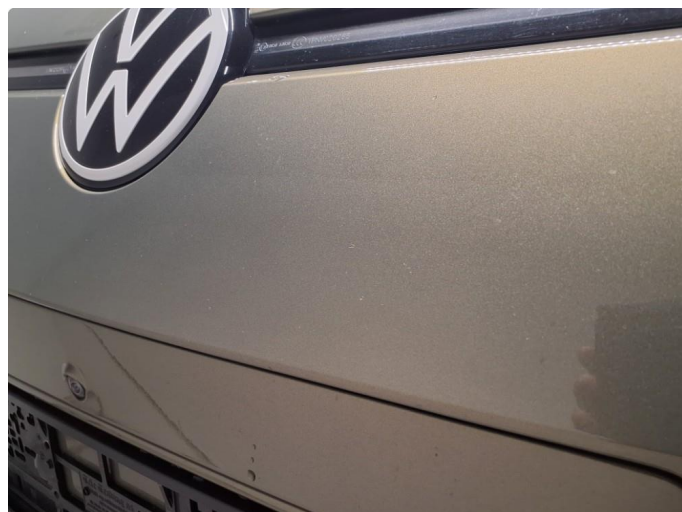
1.3 Noe steinsprut på frontfanger
