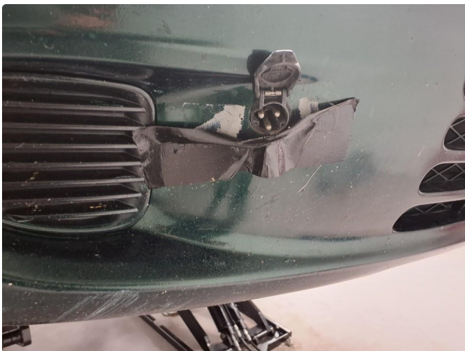
3.2 Skadet rundt kontakt til motorvarmer
