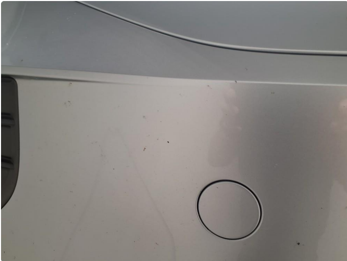
1.2 Noe steinsprut på forntfanger
