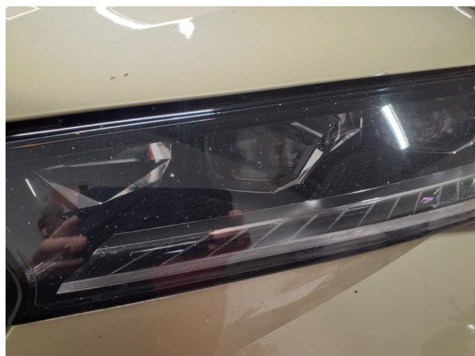
2.1 Noe steinsprut på lykter foran
