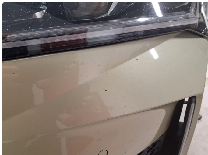
1.3 Noe steinsprut på frontfanger
