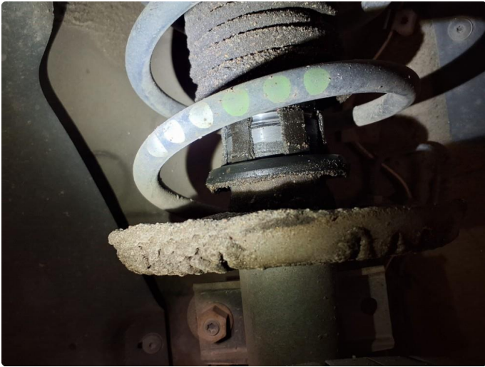
3.1 Støtdemper lekkasje , begge foran
