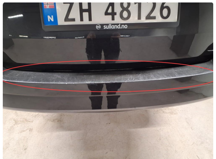
1.6 Slitasje på bakfanger
