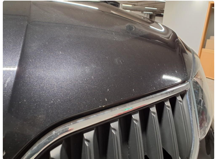
1.2 Noe steinsprut panser
