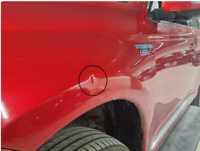
1.1 Bulk med lakkskade venstre side foran
