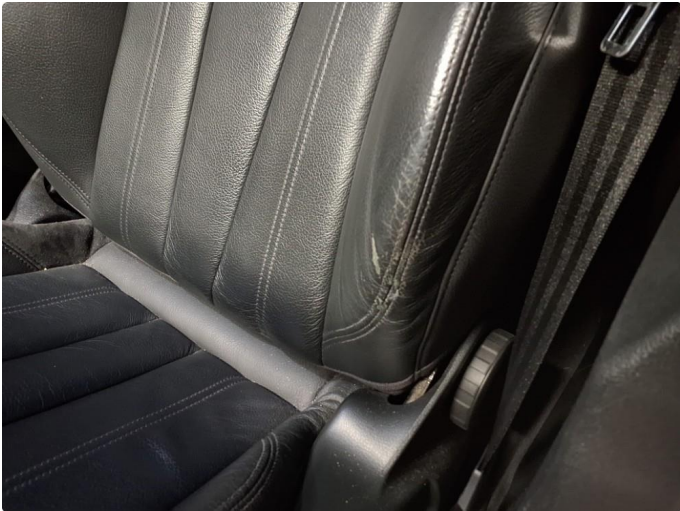
4.1 Slitasje på setetrekk, førersiden
