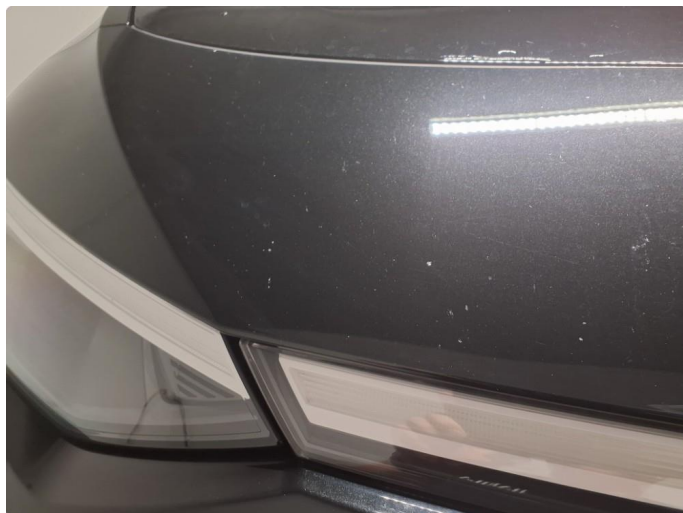
1.4 Noe steinsprut på frontfanger
