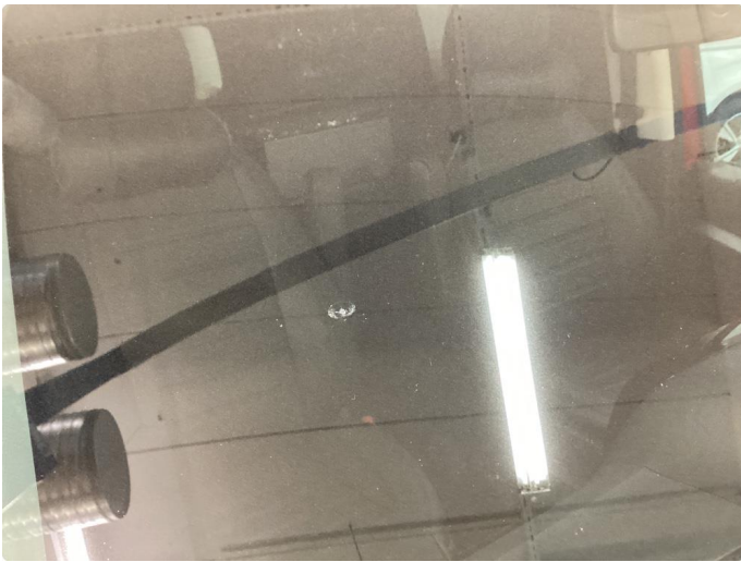
1.11 Steinsprut med sprekk
