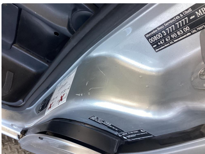
1.2 Noen riper og småbulker
