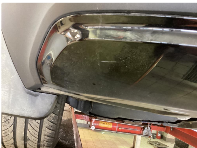
1.3 Riper på pyntelist støtfanger bak
