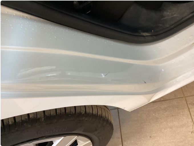
1.2 Noen små riper og små bulker
