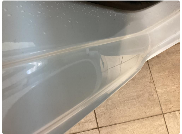
1.2 Noen små riper og små bulker
