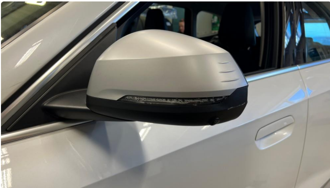
1.1 Blinklys defekt/fukt - 03.06.2026 EK - Byttet på garanti
