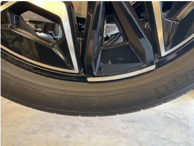
1.1 Kantkjørt felg - 26.08.26 EK - Noen små sår på felgene, ikke skeive eller kast i felg.
