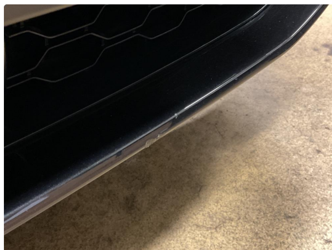
1.2 Steinsprut - 04.06.2026 EK - Normal steinsprut iht km stand, ikke noe stort.
