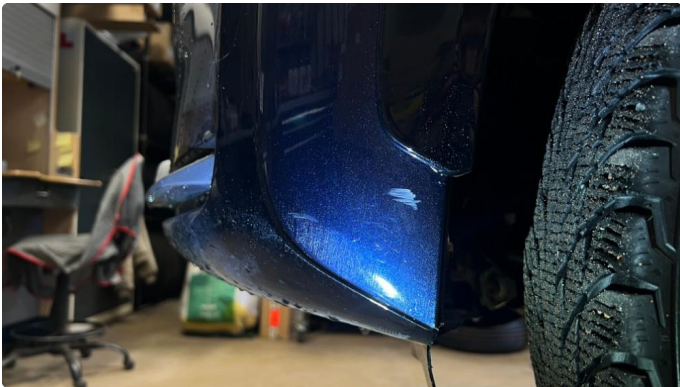
1.2 Skade - 29.04 EK - Utbedret med lakkrens
