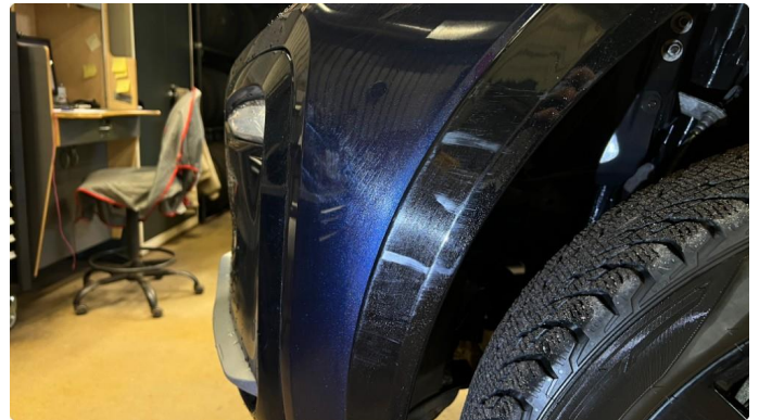
1.2 Skade - 29.04 EK - Utbedret med lakkrens
