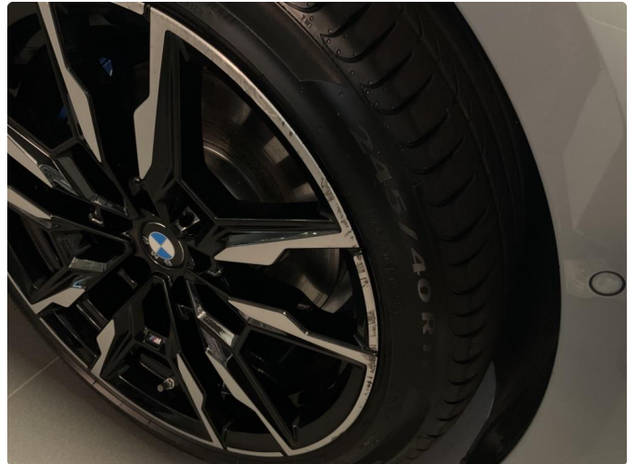
1.1 Kantkjørt felg Diamond Cut - 29.09.26 EK - Skrubbsår, men ingen kast i felg.
