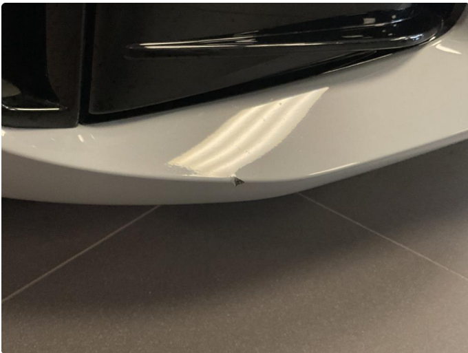
1.2 Skrubbskader underkant - 29.09.26 EK - Blir utbedret med lakkstift
