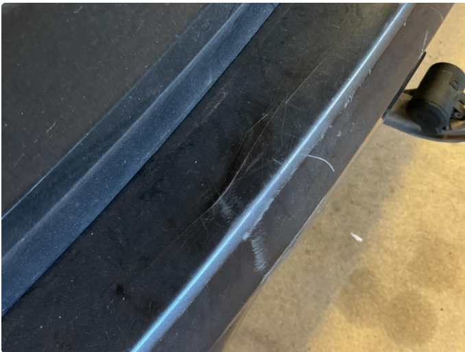
1.3 Skade - 26.08.2026 EK - Liten skade med sprekk i lakken på innlastnings område.
