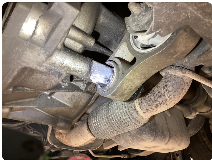
3.1 Øvrige feil Girkasse foring defekt
