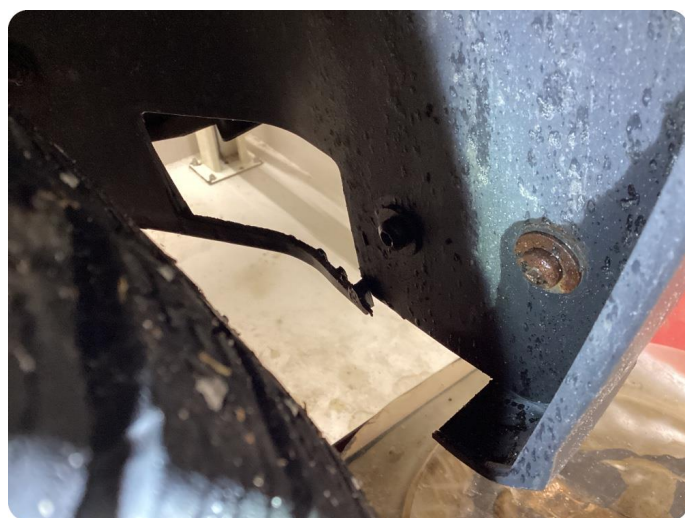
1.5 Plastinnerskjerm skadet Sprukket
