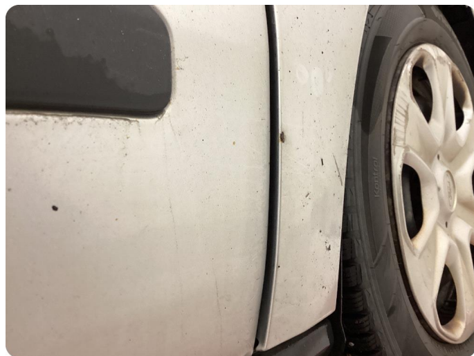
1.4 Ufagmessig utført arbeid Justering av glippe mellom skjem og dør begge sder
