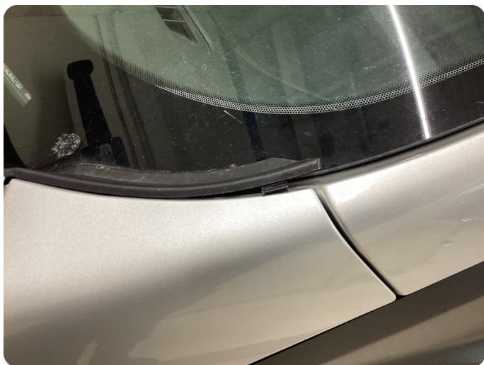
1.8 Øvrige feil Løst deksel vf
