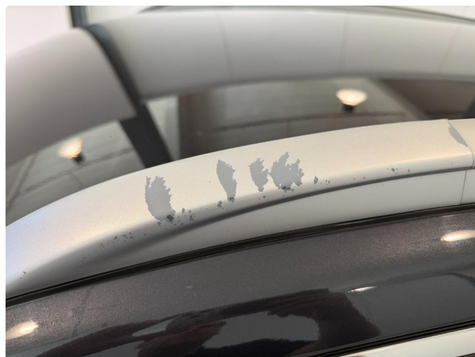
1.2 Lakk har flasket av på takrails
