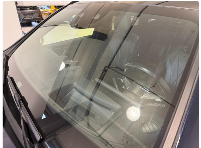
1.2 Noe slitt frontrute av steinsprut, men ingen større steinsprut eller sprekker.
