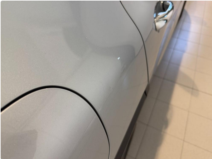
1.1 Liten parkeringsbump ved ladeluke.
