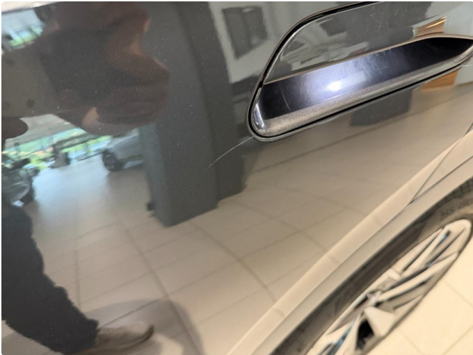
1.1 Ripe ved dørhåndtak bakdør passasjerside
