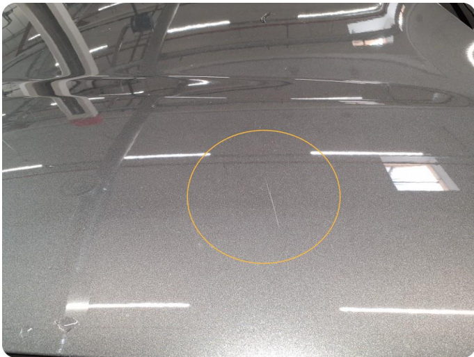
2.1 Ripe(r) ned til grunning
