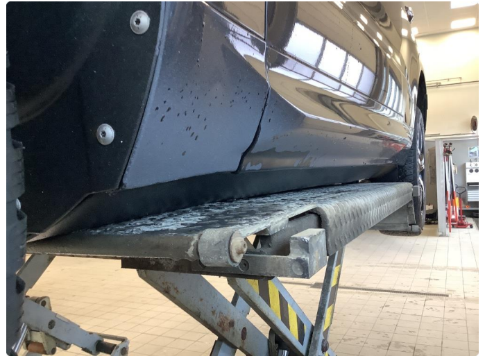
1.3 Noe slitt lakk
