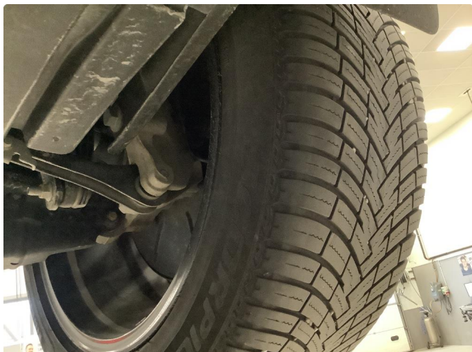
1.1 Noe skjev slitasje på sommerdekk, Firehjulskontroll er utført.
